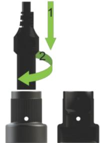
Figure 6. Connecteur de lampe
