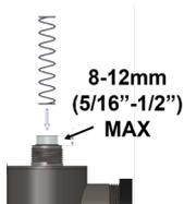
Figure 4. Installation du manchon de quartz
